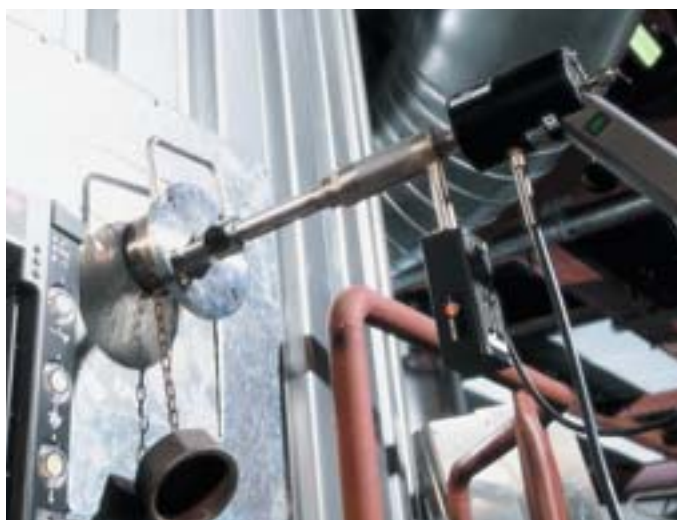
Sonde industriali per il campionamento dei gas, un sistema modulare idoneo a ogni applicazione.
