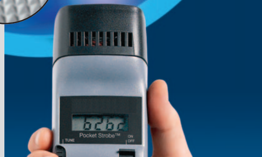
Misura della velocità di rotazione in un turbo-ventilatore
