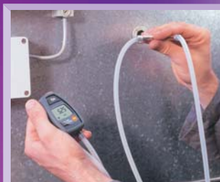
Misura della velocità e della portata d'aria con tubo di Pitot
