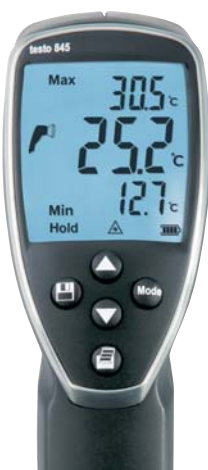
Schermata del display durante una misura a infrarossi: misura in corso, valori min./max.
