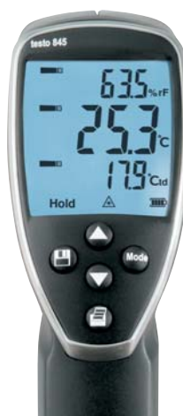
Schermata del display con modulo %UR: misura in corso dei valori di %UR, °C e °Ctd del modulo di umidità
