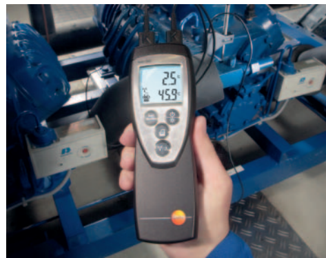
Misura simultanea di surriscaldamento e sottoraffreddamento negli impianti di refrigerazione con testo 922
