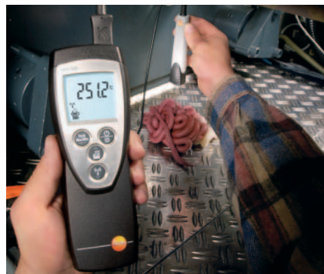
Misura della temperatura in materiali semi-solidi tramite la sonda ultrarapida a penetrazione, ideale per misure nel settore della plastica e in campo alimentare
