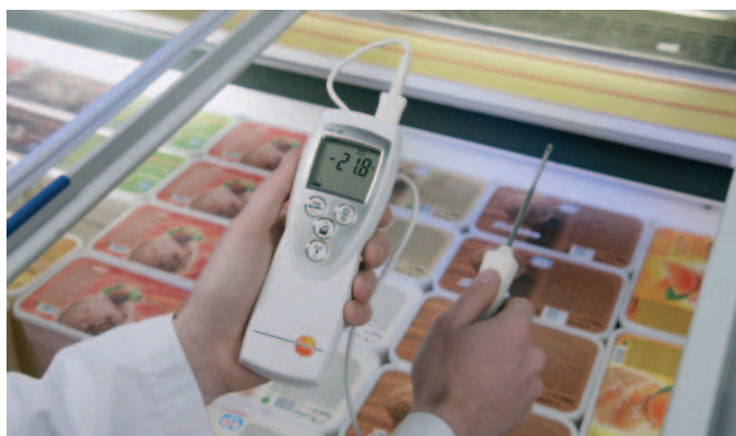
Misura della temperatura dell'aria nelle celle e nei banchi refrigerati
