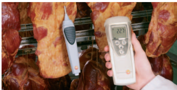
Misura della temperatura interna durante l'affumicatura degli alimenti, trasmissione radio dei dati senza cavi
