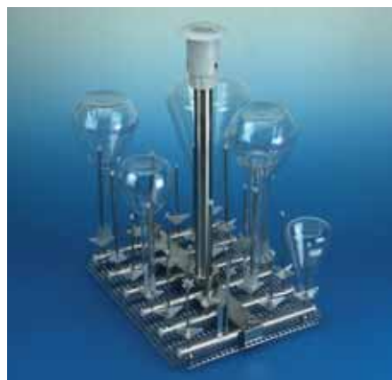
LM24 Carrello universale per il lavaggio di vetrerie a collo stretto, matracci, palloni e cilindri graduati di varie dimensioni. Ugelli di quattro dimensioni diverse. 24 posizioni. Altezza massima vetrerie 49 cm.
